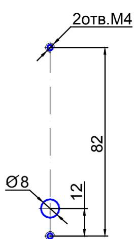
а) установка с помощью комплекта крепления КМ13 или 2-х винтов М4х16.
