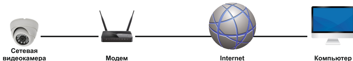
Рисунок 2-6 Доступ к видеокamera с динамическим IP адресом
